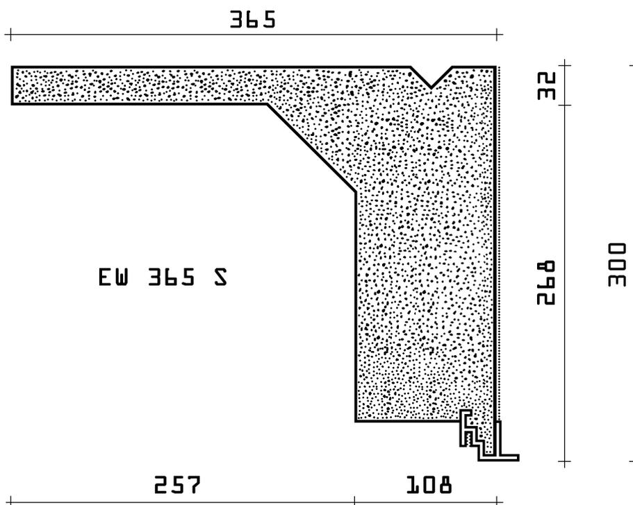
Serienmäßig haben alle Rolladenkästen der Typenreihe EW eine spezielle **Clip - Innenschiene** für den einfachen, schraublosen **EASY - CLIP - Deckelanschluss**, mit 15 mm Ausladung.
